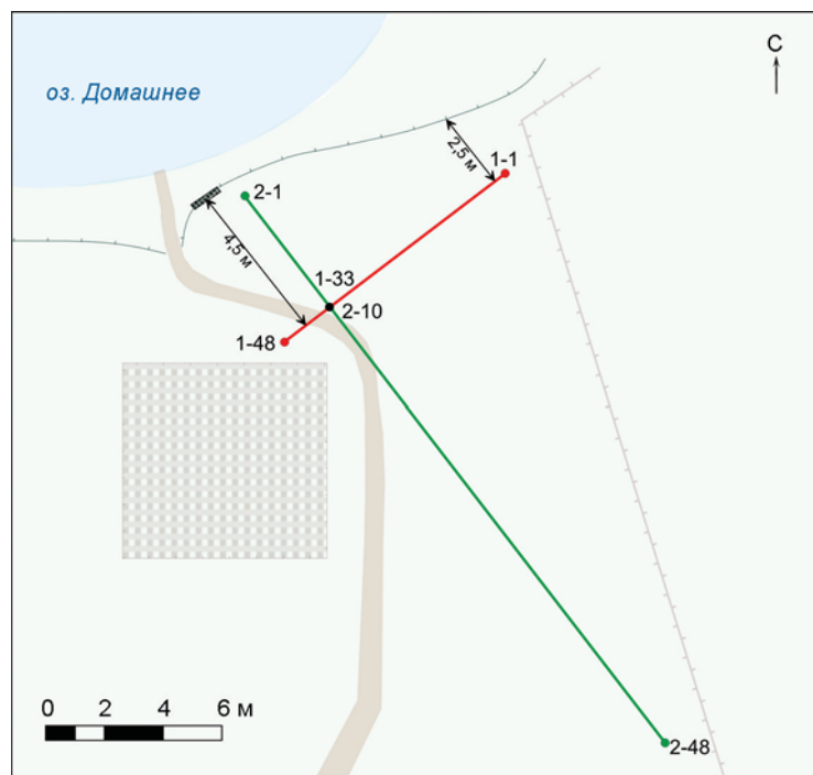
Рис. 1. Схема расположения профилей электротомографии на участке исследований памятника Домашнее озеро.
