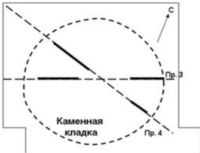
Рис. 1. Верх-Кальджин-II, курган 4. Схема профилей георадара: аномалии по профилям обозначены жирной линией.
